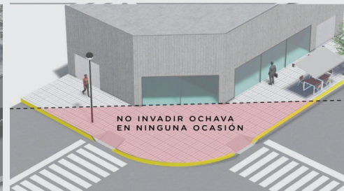
Prohibición de instalación de área gastronómica sobre la ochava
